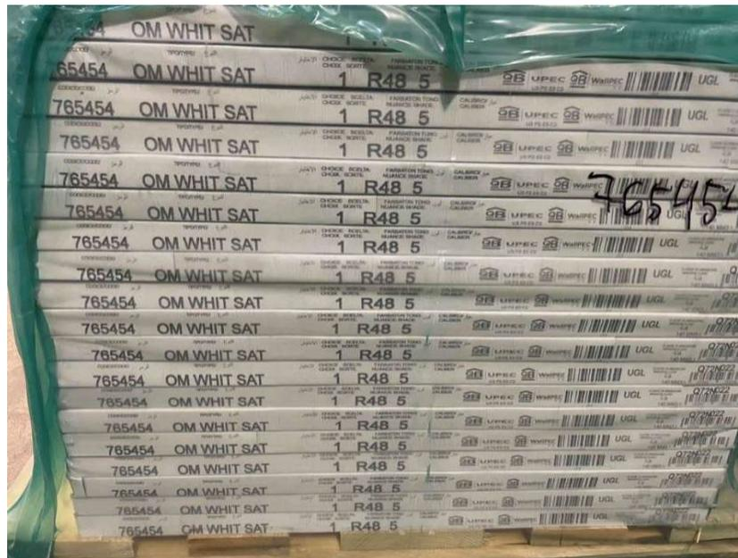
Все керамические плитки необходимо хранить в оригинальной упаковке, чтобы обеспечить максимальную защиту, избежать их взаимного трения, и упаковка должна храниться до завершения всех работ по укладке плитки.
