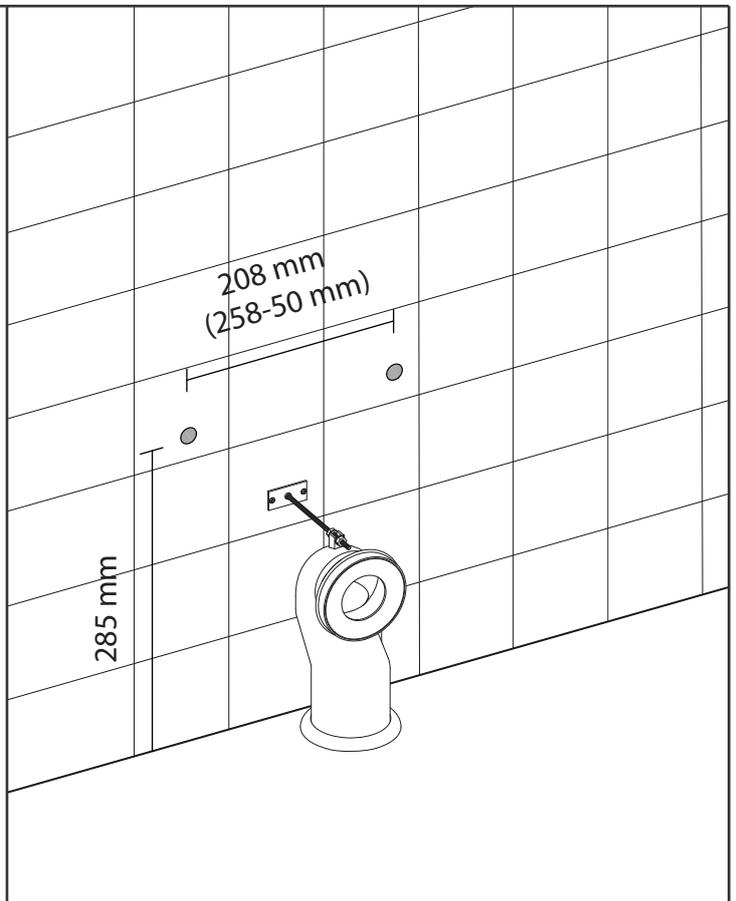
Installare gli inserti filettati ed i fissaggi
