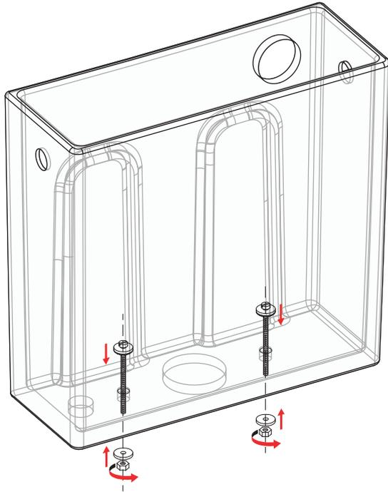
Posizionare le viti di fissaggio
