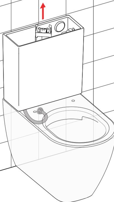
Regolare l'altezza del meccanismo per il serraggio del pulsante (riferimento regolazione E)
