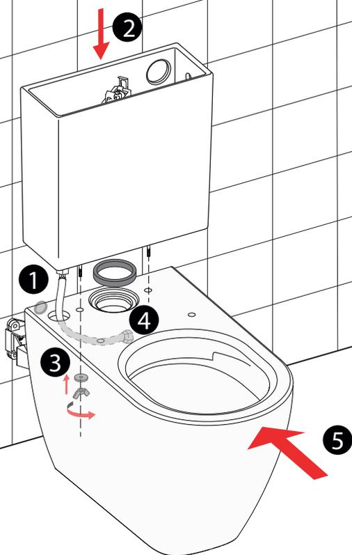
Installare la cisterna, realizzare i raccordi idraulici e posizionare il sanitario a parete
