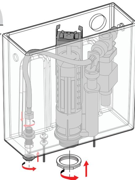
Inserire il meccanismo, serrare la flangia e realizzare il raccordo idraulico
