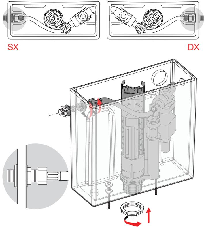
Aprire il foro predisposto per l'alimentazione esterna, posizionare le viti di fissaggio
