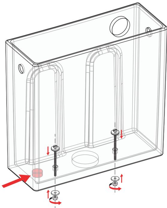
Aprire il foro predisposto per l'alimentazione retro vaso e posizionare le viti di fissaggio
