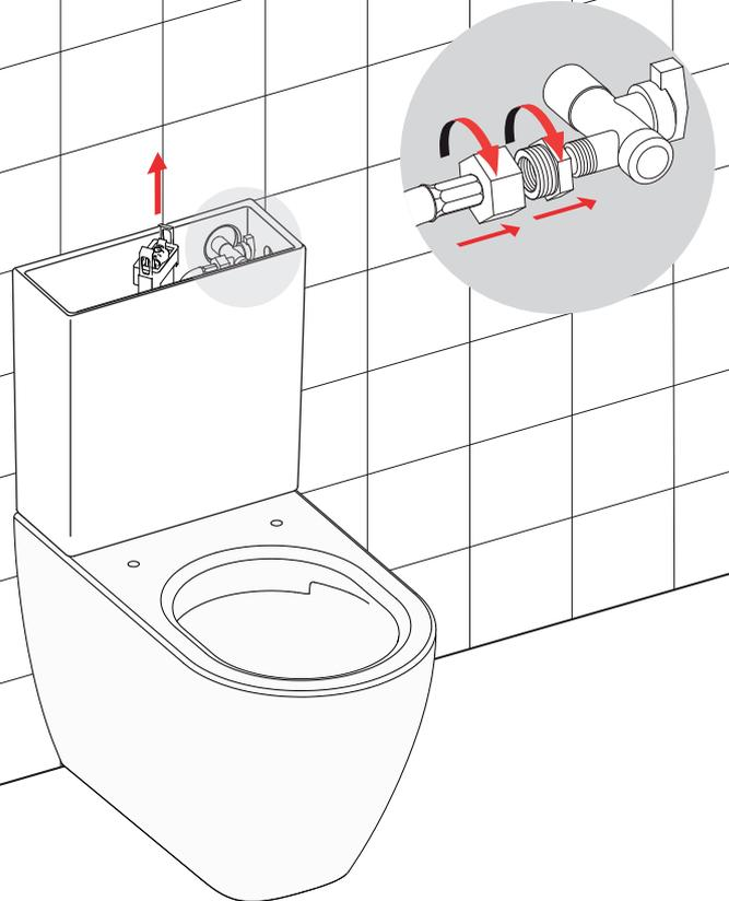
Regolare l'altezza del meccanismo per il serraggio del pulsante (riferimento regolazione E) e realizzare i raccordi idraulici (settings reference E) and make the pipe connections
